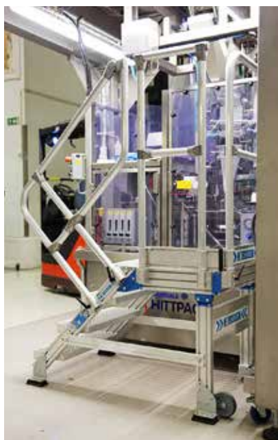
Sikker og flyttbar adkomstløsning og serviceplattform for maskiner hos Brynild.
