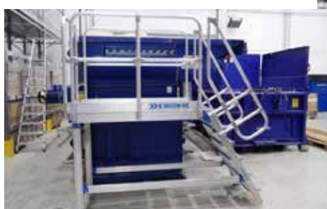
Mobil vedlikeholdsplattform på hjul med to trappeløp hos Skania.
