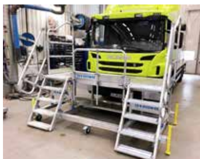
Mobil vedlikeholdsplattform på hjul med to trappeløp hos Skania.
