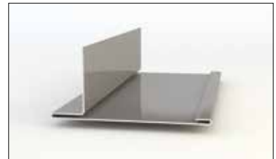
6. Swisspearl Lysningsprofil, lodret (stor) 40 x 21 x 79 mm farvet aluminiumsprofil til lodrette afslutninger omkring vinduer og døre.
